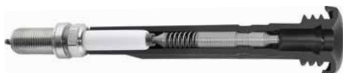
Mayor resistencia a las descargas disruptivas a pesar de una mayor tensión de encendido: gracias al aislador con cuello más largo, un mejor solapamiento, el resorte de presión rebajado y la nueva tecnología de contacto.
