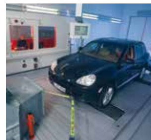
Las propiedades de las bujías para el arranque en frío se testan en el soporte móvil de tests de dos ejes en el Centro de Investigación y Desarrollo de Ludwigsburg de BERU.
