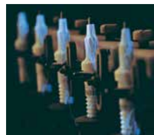
Comprobación de aisladores a 40.000 voltios: Las bujías de encendido BERU deben demostrar su fiabilidad en el banco de pruebas antes de la fabricación en serie.
